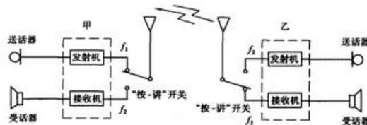
图 1.2 异频单工通信方式示意图
