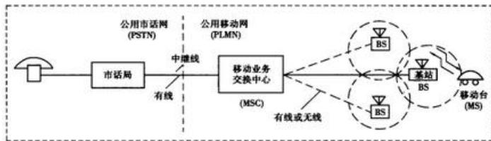
图 1.1 移动通信系统的组成
